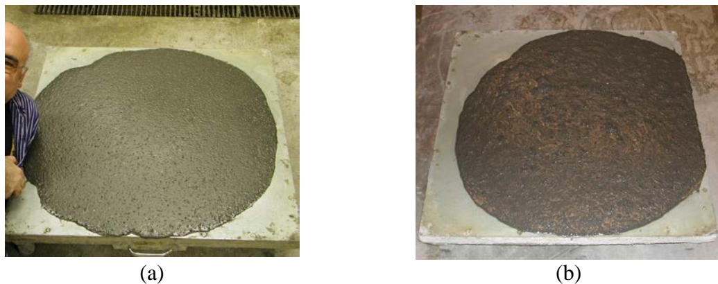
Figur-2: Sättmåttprov av betong (a) utan fibrer och (b) med fiber innehåll, V_f = 1.5\%
